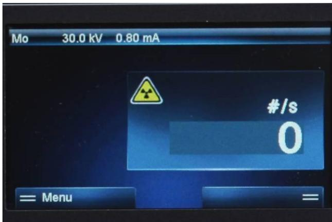
Abb. 11: Bildschirm zur Gerätesteuerung an der Vorderseite des Gerätes. Hochspannung ist aktiviert. Das Symbol
